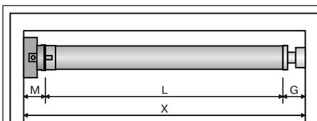
Ermitteln Sie den seitlichen Platzbedarf (M) durch Messen von Antriebskopf und Wandlager. Das lichte Maß des Kastens (X) abzüglich des seitlichen Platzbedarfes (M) und Gegenlager (G) ergibt die Länge (L) der Wickelwelle:  $L=X-M-G$ .
