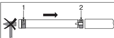
Montieren Sie den Rohrantrieb mit entsprechendem Ring (1) und Mitnehmer (2). Falls der Ring mehrere Nuten besitzt, wählen Sie die passgenaue Nut aus und schieben den Ring (1) auf den Laufring.
