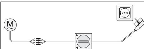
Die Inbetriebnahme kann mit der Schaltergarnitur (Art.-Nr. 4901 001 158 0) oder dem vorgesehenen Bedienelement erfolgen.
