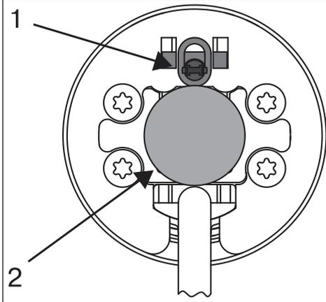
Der Steckzapfen (2) rastet beim Einschieben automatisch ein. Zum Lösen des Steckzapfens (2) das Sicherungsblech (1) nach oben schieben und den Steckzapfen (2) herausziehen.
