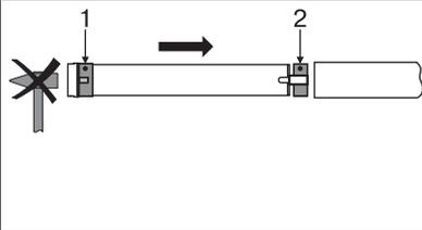
Montieren Sie den Rohrantrieb mit entsprechendem Ring (1) und Mitnehmer (2). Falls der Ring mehrere Nuten besitzt, wählen Sie die passgenaue Nut aus und schieben den Ring (1) auf den Lauftring.
