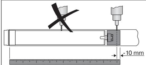
Um eine sichere Übertragung des Drehmomentes bei Rundwellen sicherzustellen, empfehlen wir den Mitnehmer mit der Welle zu verschrauben (siehe nachfolgende Tabelle).
