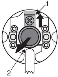
Der Steckzapfen (2) rastet beim Einschieben automatisch ein. Zum Lösen des Steckzapfens (2) das Sicherungsblech (1) nach oben schieben und den Steckzapfen (2) herausziehen.
