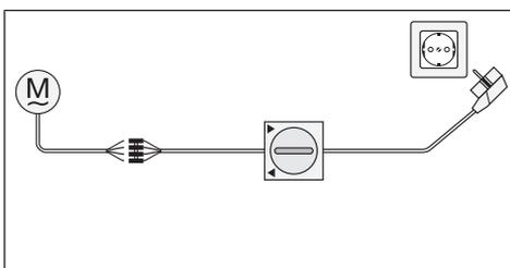
Die Inbetriebnahme kann mit der Schaltergarnitur (Art.-Nr. 4901 001 158 0) oder dem vorgesehenen Bedienelement erfolgen.
