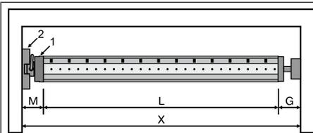
Ermitteln Sie den seitlichen Platzbedarf (M) durch Messen von Antriebskopf (1) und Wandlager (2). Das lichte Maß des Kastens (X) abzüglich des seitlichen Platzbedarfes (M) und Gegenlager (G) ergibt die Länge (L) der Wickelwelle:  $L=X-M-G$ .
