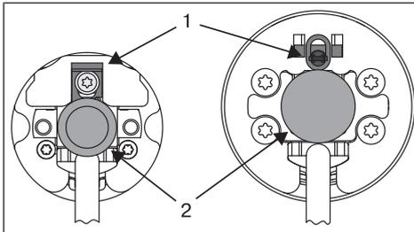
Der Steckzapfen (2) rastet beim Einschieben automatisch ein. Zum Lösen des Steckzapfens (2) das Sicherungsblech (1) nach oben schieben und den Steckzapfen (2) herausziehen.
