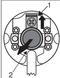
Der Steckzapfen (2) rastet beim Einschieben automatisch ein. Zum Lösen des Steckzapfens (2) das Sicherungsblech (1) nach oben schieben und den Steckzapfen (2) herausziehen.
