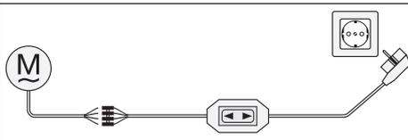
Verbinden Sie die Anschlusslitzen des Rohrantriebes farbengleich mit denen der Schaltergarnitur (Art.-Nr. 4901 002 181 0) bzw. des Bedienelementes und schalten Sie die Netzspannung ein.
