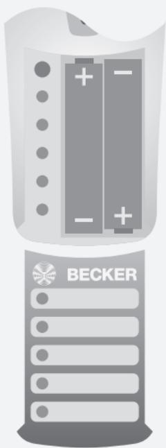
1. Open de afdekking van het batterijvak.
