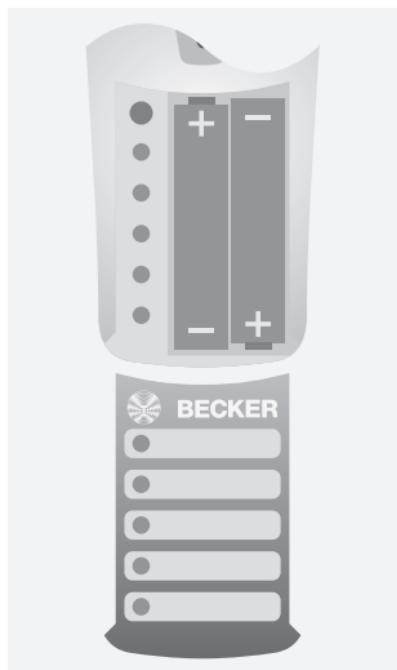
1. Öffnen Sie die Abdeckung des Batteriefachs.
