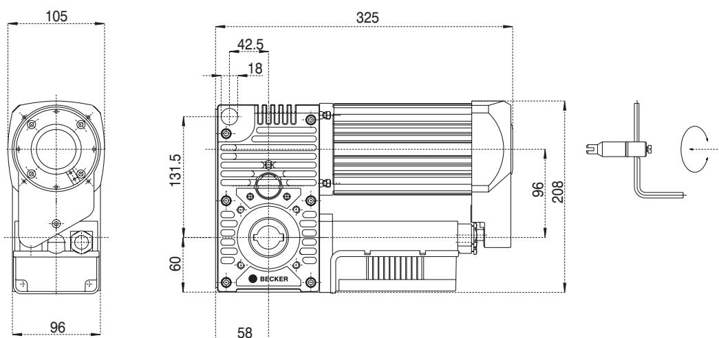
Aufsteckantriebe sind für den Antrieb von Sektional- und Rolltoren vorgesehen. Andere Anwendungen sind nur nach Genehmigung durch die Firma BECKER-Antriebe zulässig.
