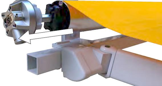
Entfernen Sie das Getriebe.
