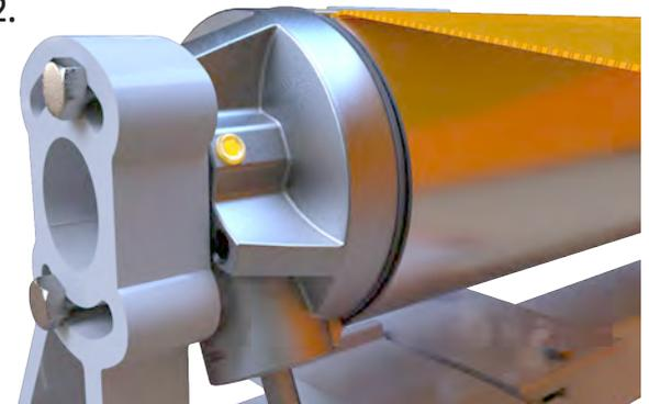
Setzen Sie den Anschlag, indem Sie den Gewindestift wieder hinein drehen.
