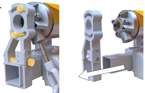
Demontieren Sie den Getriebehalter.
