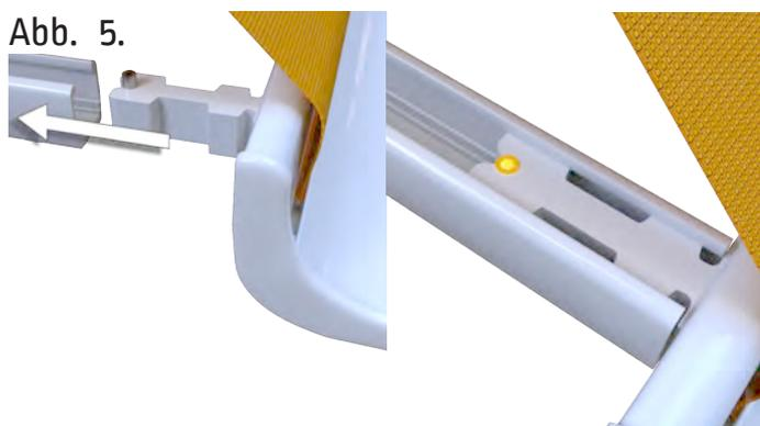
Stecken Sie den Ausfallprofilhalter wieder in das Armprofil und fixieren es mit dem Gewindestift [Abb.2, Pos.7].
