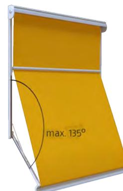
Der Öffnungswinkel darf nicht größer als  $135^\circ$  sein, da sonst der Hub der Gasfeder beim Schließen der Anlage nicht ausreicht. Dieses kann zu einer Beschädigung an der Gasfeder oder dem kpl. Armsystem führen.
