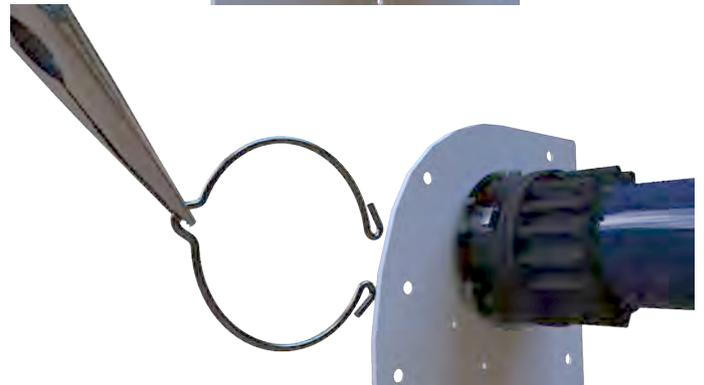
Lösen Sie den Sicherungsring...
