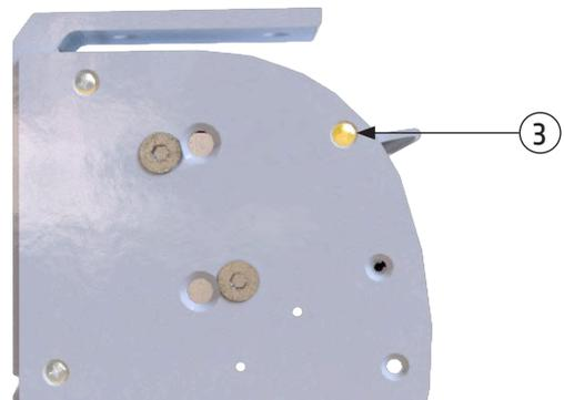
Montieren Sie nun das Abdeckprofil am Gehäuse und fixieren es mit einer Schraube [3] auf beiden Seiten der Markise.
