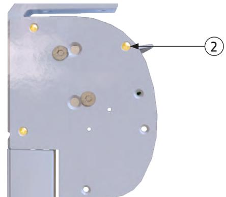
Lösen Sie die Schrauben des Seitenblechs. Beginnen Sie mit der vorderen Schraube **[2]**.
