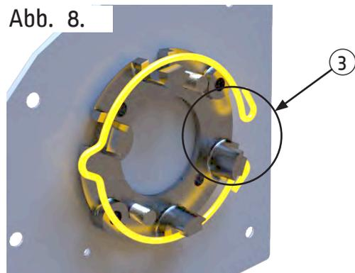
Stecken Sie den Sicherungsring wieder auf das Motorlager auf.
