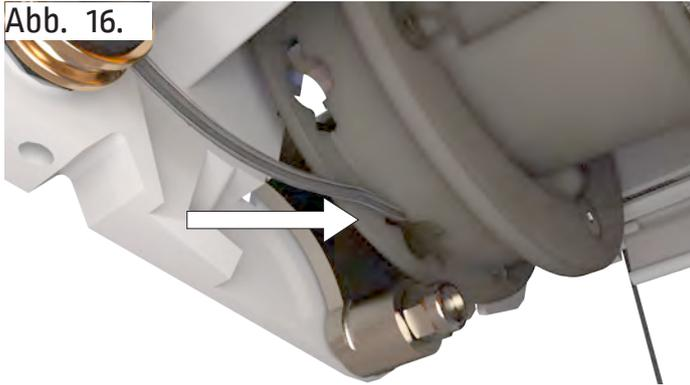
Fahren Sie das Ausfallprofil so weit aus, dass sie den Punkt der Bandscheibe sehen, an dem das Band eingeklemmt ist.
