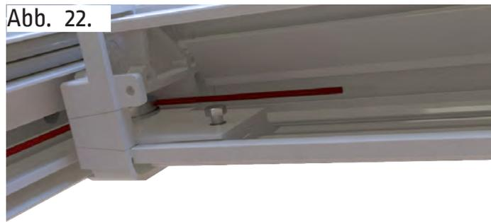
Legen Sie das Zugband um die Rolle des Radhalters im Ausfallprofil.
