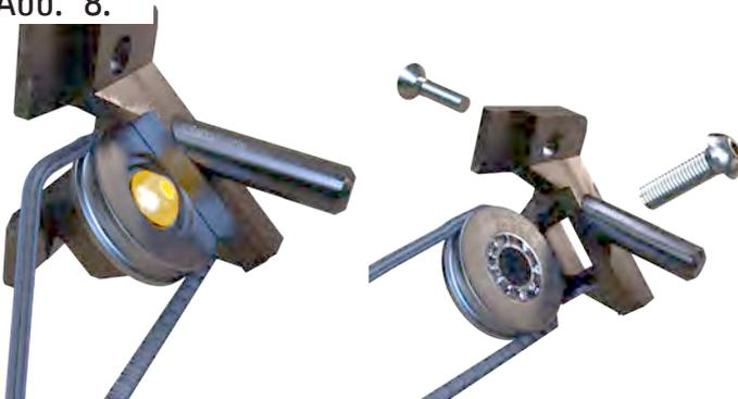
Nehmen Sie die Umlenkung heraus und lösen Sie die Rolle. Nun kann das Band entnommen werden.
