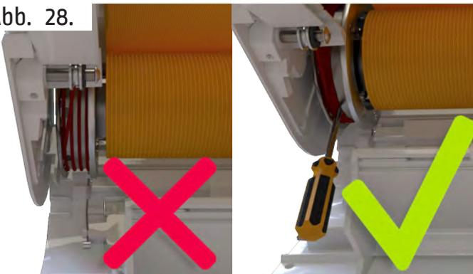
Das Zugband muss sich auf der Außenseite der Bandscheibe befinden, ggf. unter Zuhilfenahme eines Schraubendrehers nach „AUSSEN“ drücken.
