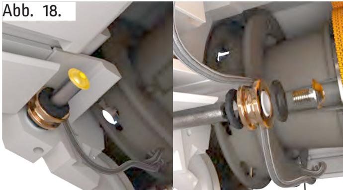
Nun demontieren Sie das Laufrad, um auch hier das Band zu entfernen.
