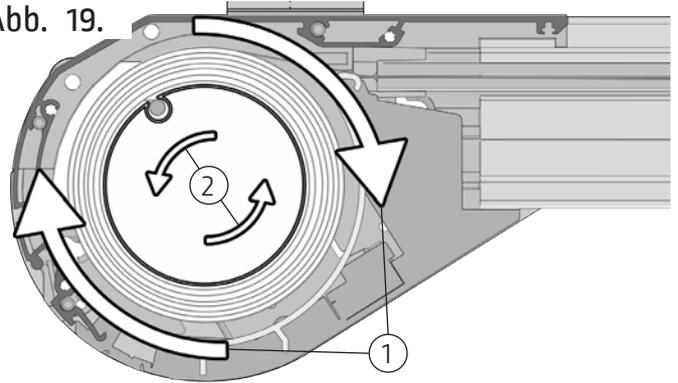
Legen Sie das Zugband (Laufrichtung 1) entgegengesetzt zur Wickelrichtung des Tuches (Laufrichtung 2) auf die Gurtbandscheibe.
