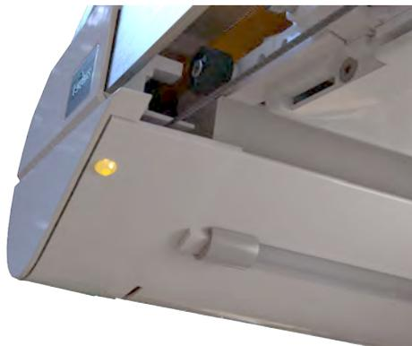
Öffnen Sie das Gehäuse durch entfernen der Innensechskantschraube.
