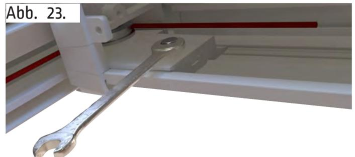
Schieben Sie den Radhalter nach außen und fixieren ihn mit der Sechskantschraube.
