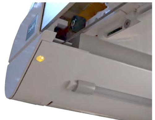
Sichern Sie den Gehäusedeckel mit der Innensechskantschraube.
