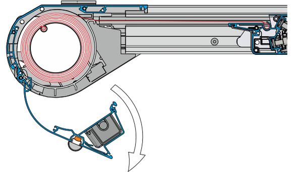
Öffnen Sie das Gehäuse. Drücken Sie es dazu leicht nach hinten und haken es aus.
