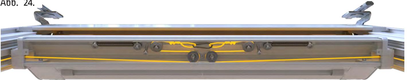
Bandverlauf bei einer Anlagenbreite von unter 310 cm:
