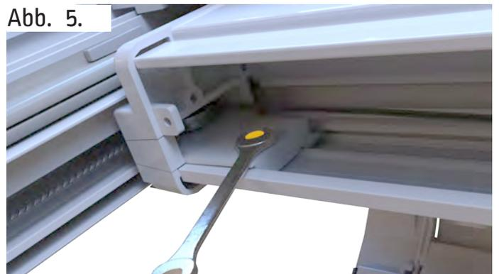
Lösen Sie die Sechskantschraube am Radhalter.
