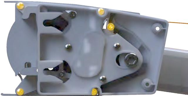
Lösen Sie die Schrauben der Gehäuseabdeckung.
