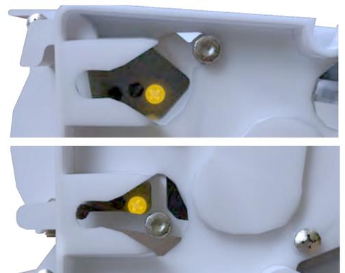
Lösen Sie die Getriebeschrauben.
