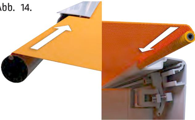
Schieben Sie die Tuchwelle mit dem neuen Tuch seitlich in das Gehäuseprofil ein. **Beachten Sie hier den richtigen Sitz des Tuchwellenlagers auf der Lagerseite.** Ziehen Sie dabei das neue Tuch in die Kedergasse des Ausfallprofils ein und schrauben die Kederdübel wieder fest.
