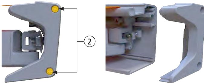
Lösen Sie die Blechschrauben [2] der Abdeckkappen des Ausfallprofils auf beiden Seiten und entfernen Sie die Abdeckkappen des Ausfallprofils mit einem PVC-Hammer.
