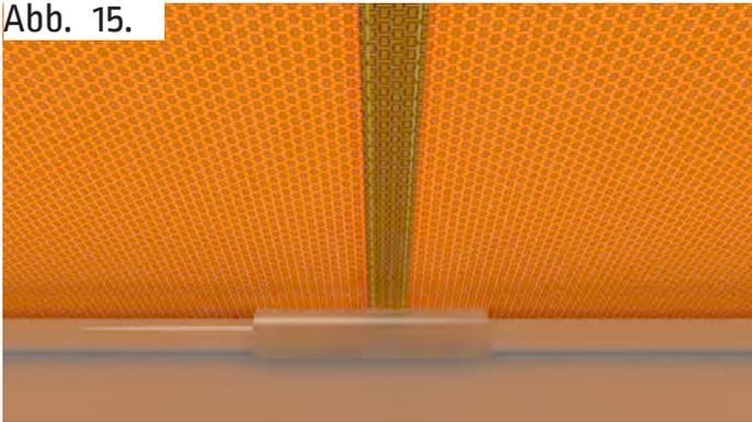
Richten Sie die Gleitschalen am Tuchleitblech nach der Tuchnaht aus.
