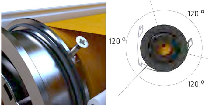
Schieben Sie den Motor in die Tuchwelle und drehen Sie die 3 Blechschrauben zur Befestigung der Gurtbandscheibe hinein.
