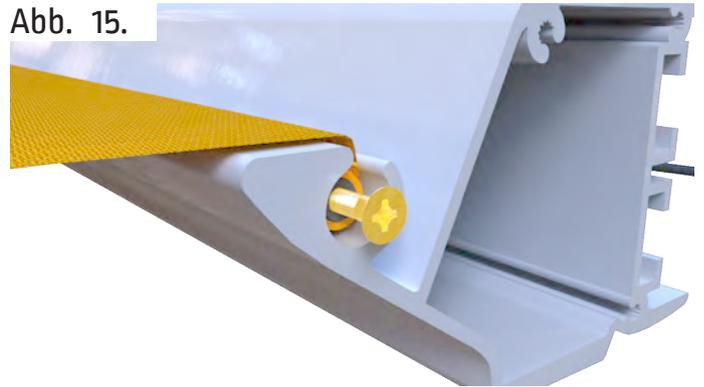
Lösen Sie die Kederschrauben auf beiden Seiten im Ausfallprofil.
