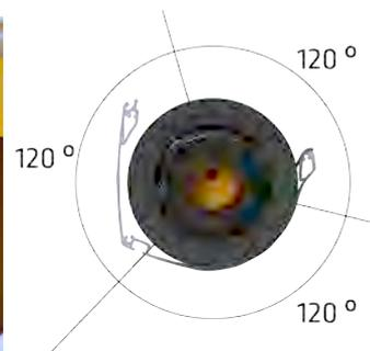
Drehen Sie die 3 Blechschrauben zur Befestigung der Gurtbandscheibe heraus. Diese befinden sich im 120° Abstand zueinander.
