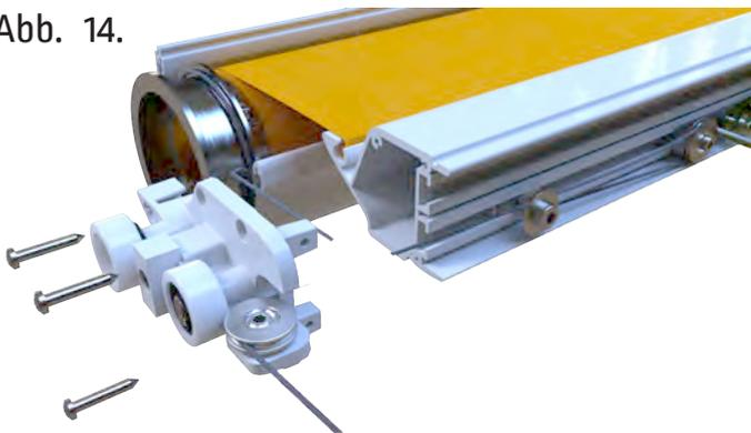
Entfernen Sie die Laufwagen auf beiden Seiten.
