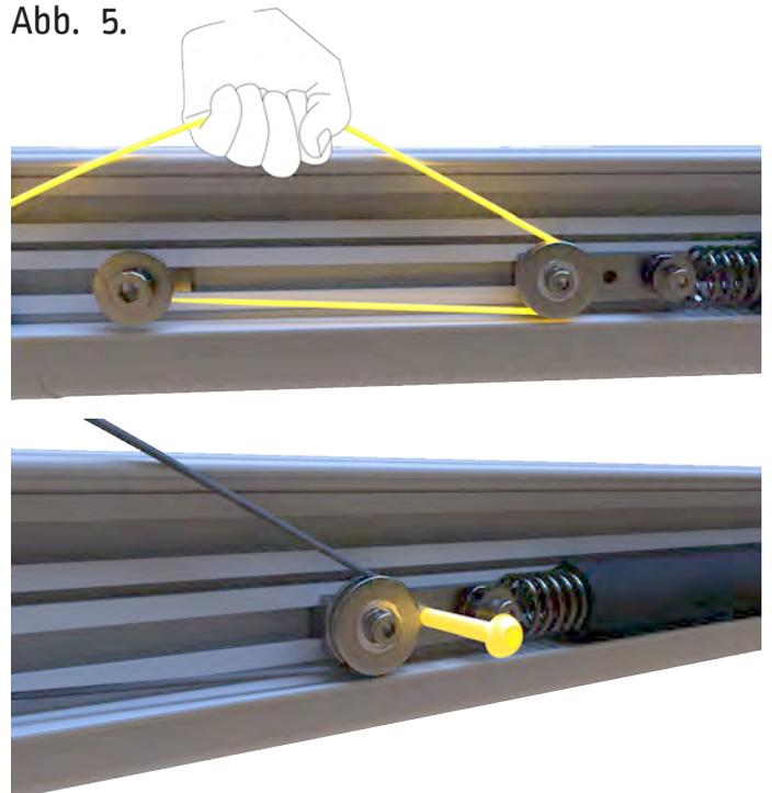
Sichern Sie die Vorspannung der beiden Federn durch je eine Arretierungsschraube.
