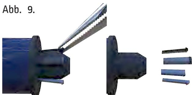
Entfernen Sie die Widerhaken vom Motorende.
