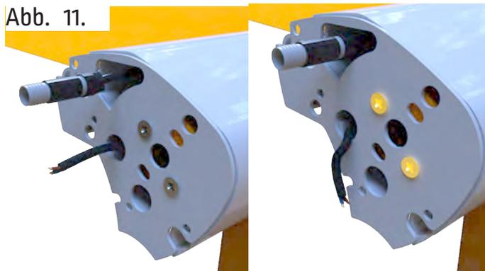
Fädeln Sie das Motorkabel durch das Seitenblech und montieren Sie das Seitenblech am Motor.
