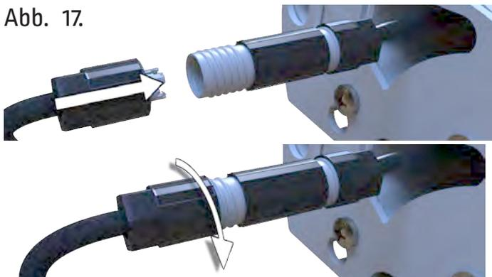
Verbinden Sie den Motor wieder mit dem Rundsteckverbinder.
