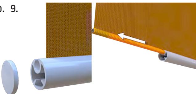
Entfernen Sie die Kappe des Beschwerungsprofils und ziehen Sie das Tuch seitlich aus dem Beschwerungsprofil heraus.
