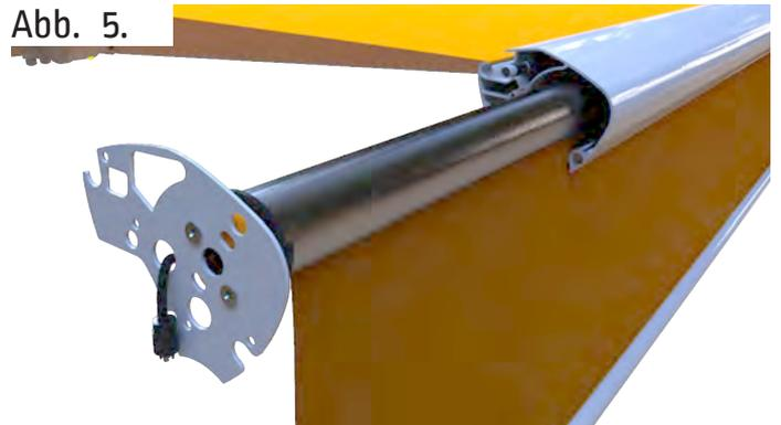
Entfernen Sie das Seitenblech samt Motor und Tuchwelle seitlich aus dem Ausfallprofil.
