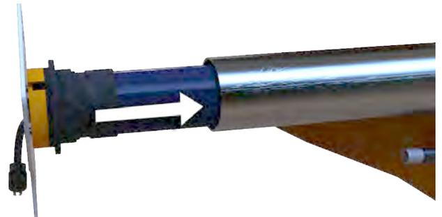
Schieben Sie den Motor vollständig in die Tuchwelle.
