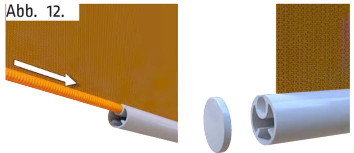
Schieben Sie das Beschwerungsprofil seitlich auf das neue Tuch und montieren Sie die Abdeckkappe.
