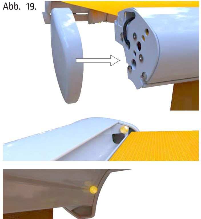
Montieren Sie die Abdeckkappen für Gehäuse und Ausfallprofil.
