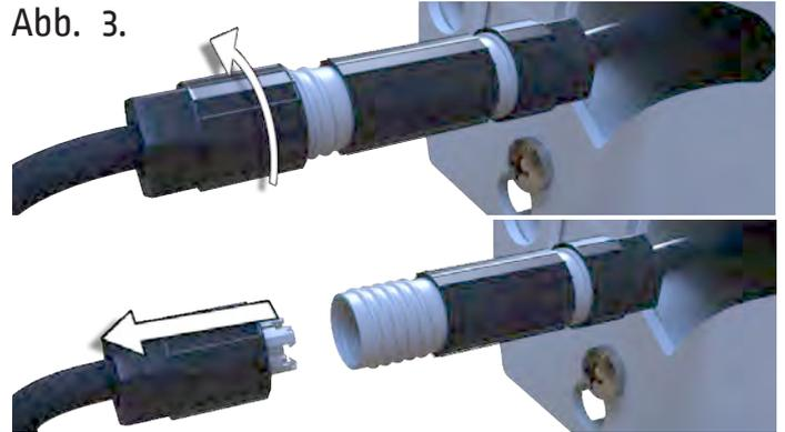
Trennen Sie das Motorkabel vom Rundsteckverbinder.
