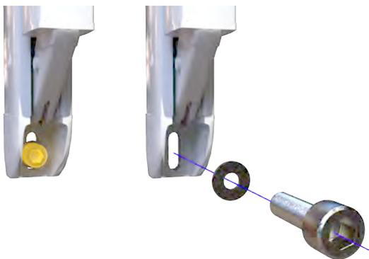
Lösen Sie im eingefahrenen Zustand die untere Schraube des Hinterfallarmprofils.
