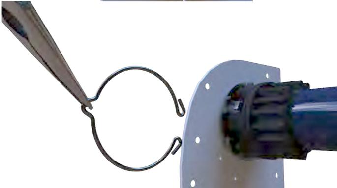
Lösen Sie den Sicherungsring...
