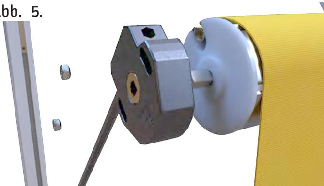
Entfernen Sie das Getriebe.
