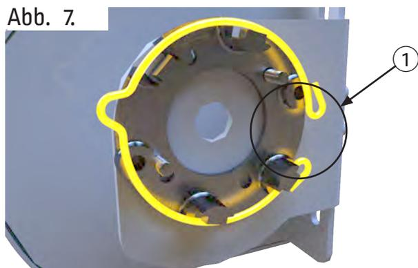
Stecken Sie den Sicherungsring wieder auf das Motorlager auf.
