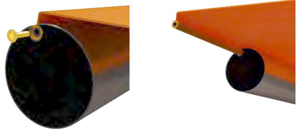
Lösen Sie die Kederdübel auf beiden Seiten der Tuchwelle und ziehen Sie das Tuch seitlich heraus.
