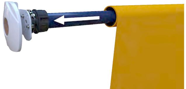
Ziehen Sie den Motor mit Seitenblech aus der Tuchwelle.
