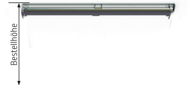
Die Oberkante des Wandprofils entspricht der Bestellhöhe.
