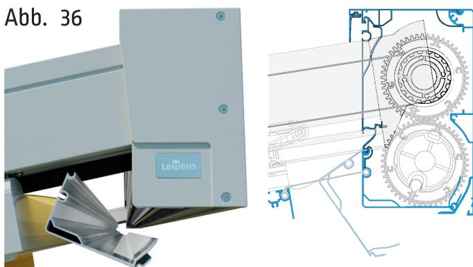
Fahren Sie die Anlage ein, bis sie Das untere Abdeckprofil am vorderen Abdeckprofi montieren können.
