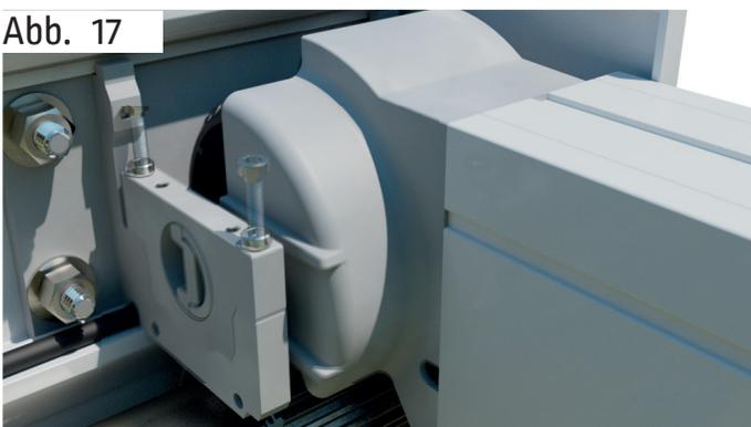
Befestigen Sie den Schienenhalterereinsatz mit den zuvor entnommenen Schrauben.
