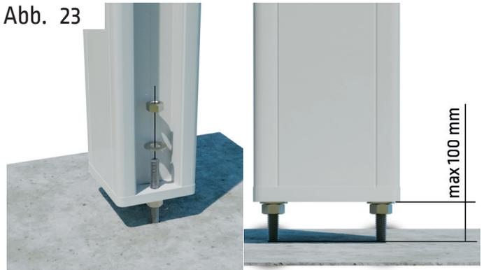
Die Pfosten über die Fundamente zurück schieben. Dabei die Schraublöcher am Fuß der Pfosten über die Bolzen führen und Unterlegscheiben auflegen. Unterlegscheiben auflegen und obere Haltemuttern aufschrauben. Durch die unteren und oberen Haltemuttern kann die Montagehöhe millimetergenau justiert werden.
