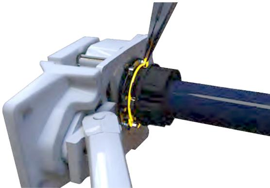
Lösen Sie den Sicherungsring und entfernen Sie den Motor.
