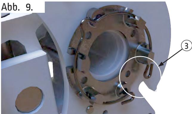
Stecken Sie den Sicherungsring wieder auf das Motorlager auf.
