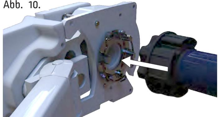
Stecken Sie den neuen Motor auf das Motorlager.
