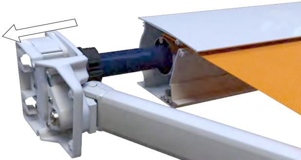
Entfernen Sie die Gehäuseabdeckung samt Armhalter und Entfernen Sie den Motor / das Getriebe komplett aus der Tuchwelle..
